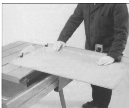
De ruiter hoogklappen en het werkstuk opleggen. Machine opstarten en het werkstuk haaks verzagen.
